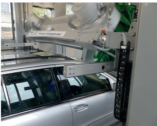
Blasen die letzten Tropfen weg: die schwenkbaren Trockner. Danach tummeln sich Teddytex-Streifen auf dem Fahrzeug.
